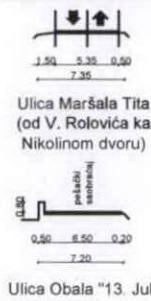
Tipični poprečni profili sabirne ulice
