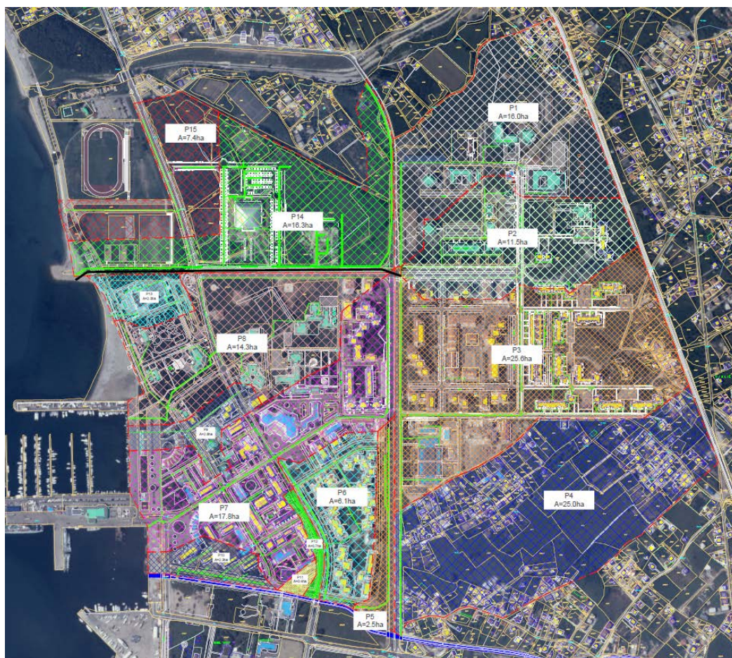
Slika 3: Slivne površine šireg područja centra Bara – stanje nakon izgradnje kanala duž Bulevara Revolucije a prije početka realizacije DUP-a „Topolica III - izmjene i dopune“
