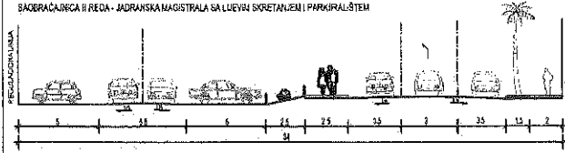
PRESJEK 18-16: SAOBRAĆAJNICA II REDA - JADRANSKA MAGISTRALA SA LIEVINI SKRETANJEM I PARKIRALIŠTEM
